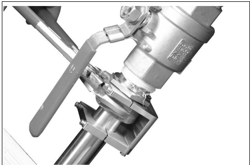
4-36 ábra Meglazítás érzékelő kisereléséhez
