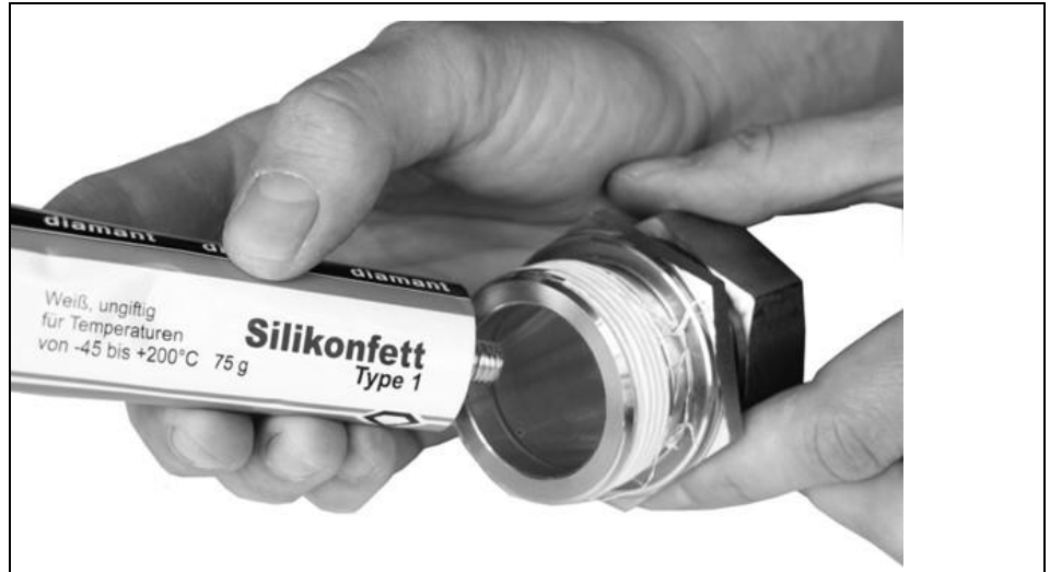
4-29 ábra Az érzékelő tömítőidom zsírozása
