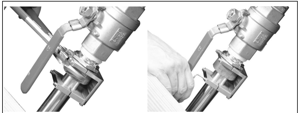
4-38 ábra Érzékelő ismételt rögzítése a beszerelésnél
