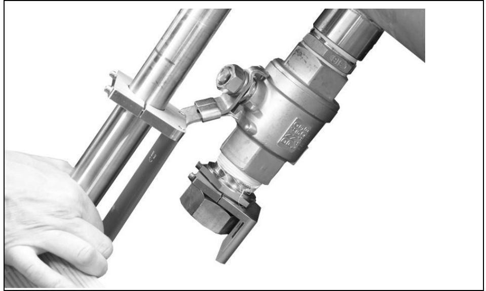
4-37 ábra Érzékelő eltávolítása (tisztítás/ellenőrzés)
