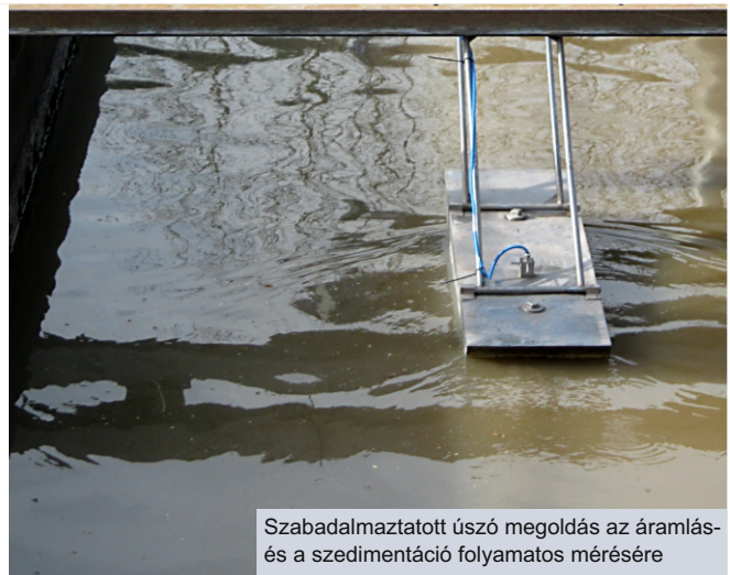
Alternatíva az indukciós áramlásmérőkre: beépítés a régi indukciós áramlásmérő eltávolítás nélkül.
